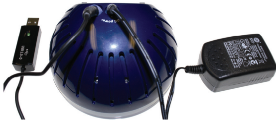
Abb. 5: Anschluss von Netzteil und Datenübertragungskabel auf der Geräterückseite
