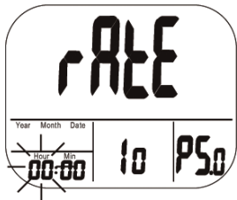
Afb. 17: Instellen van de aftastfrequentie (uren)
