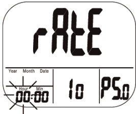
Abb. 19: Einstellen der Abtastrate (Stunden)
