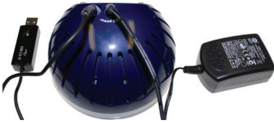
Afb. 5: Aansluiting van adapter en data-overdrachtskabel aan de achterkant van het apparaat
