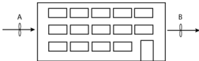
Afb. 5.3 Gebouw met aparte mechanische luchttoe- en afvoer
